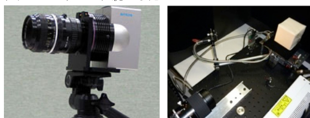
図 3 撮影に用いた高精細冷却 CCD カメラ Figure 3 Cold CCD Camera
