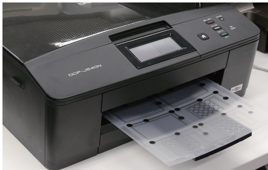
図1 複合機を用いたマルチタッチインタフェースの印刷
