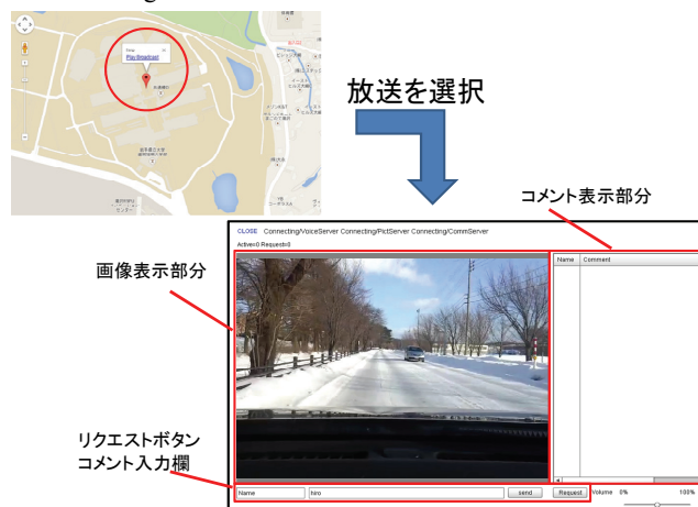
図 5 視聴者クライアント(PC)のユーザインタフェース Figure5 User interface of an audience client (PC)
