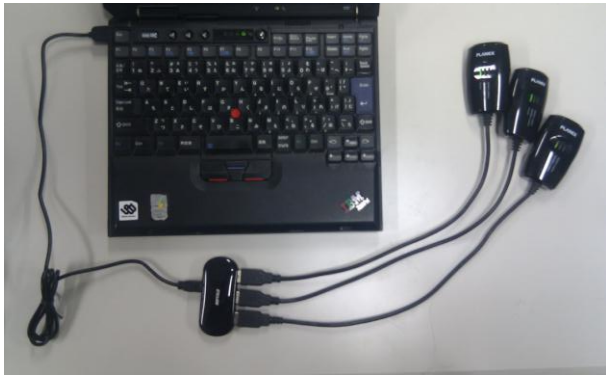
図 7 OpenFlowSwitch デバイス構成
