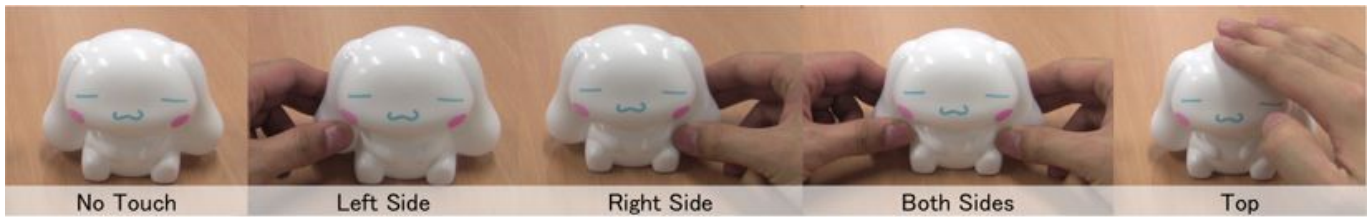
図 5 プラスチック製の玩具における 5 種類のタッチジェスチャ。
