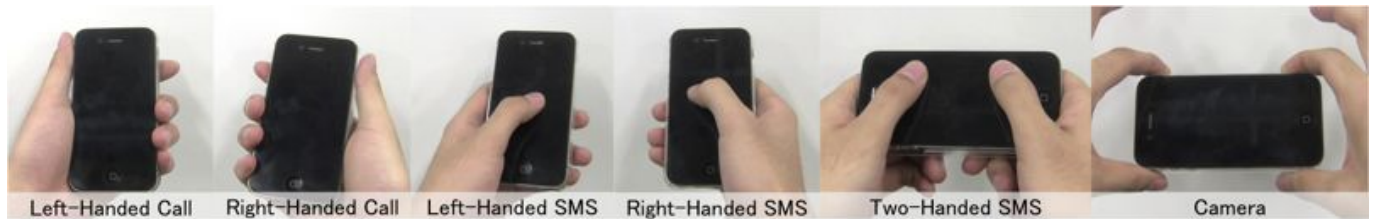
図 11 携帯情報端末における 6 種類の把持状態。 Fig. 11 Six hand postures for posture recognition.
