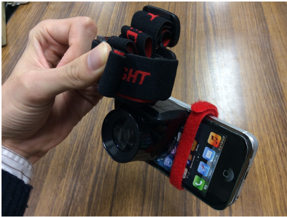
図 4 スマートフォンと拡大鏡による HMD Fig. 4 HMD by SmartPhone and Magnifying Lens
