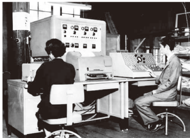
日本電子測器で開発されたPD 1516パラメトロン計算機 (右側は高橋秀俊氏)
