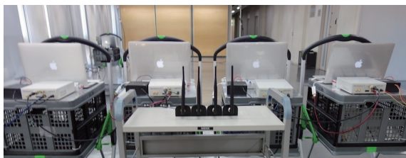
図 4 6 cm 間隔で配置した移動局アンテナ
