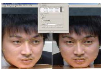
図1 フォトカルクツビューで顔のポリゴンモデルを作成するための画像セット例 (黄色の点群は手動で指定されている)
