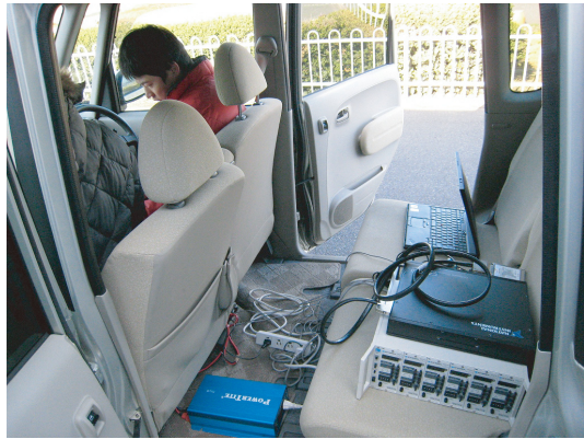
図 3 実車試験の準備の様子
