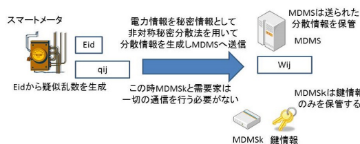
図5 非対称秘密分散法を適用したスマートグリッドシステム Fig. 5 Smart grid system applied Asymmetric secret sharing.
