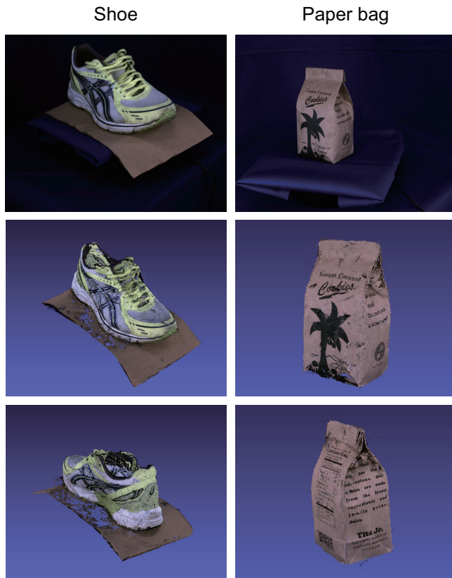
図 5 提案手法を用いた靴と紙袋の 3 次元復元結果 (上から 1 行目: 3 次元復元対象, 2-3 行目: 3 次元復元点群)
