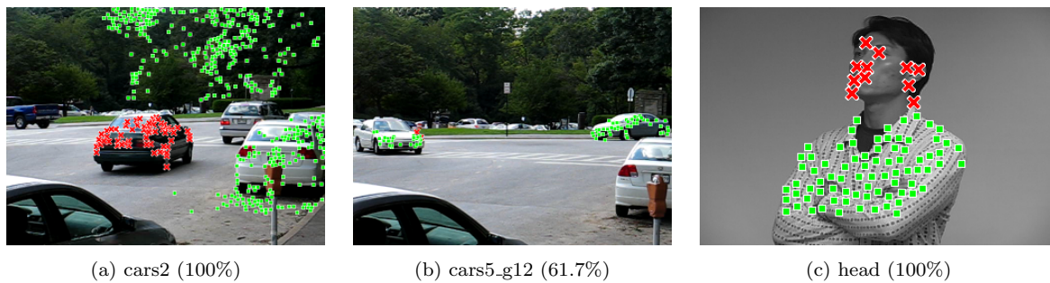
図 10 誤追跡の除去後の運動分離結果. 括弧内は運動分離の正解率.
