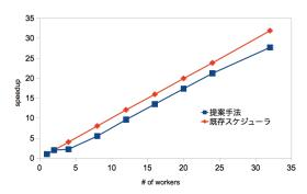
図 **5** フィボナッチ数列の並列計算の台数効果 Fig. 5 Speedup for the parallel fibonacci
