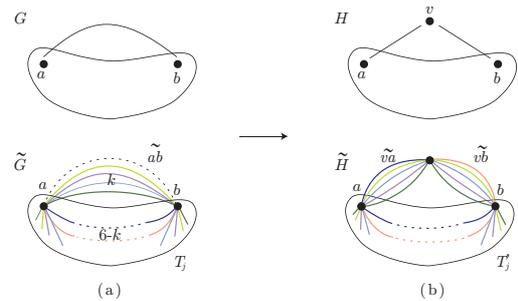
図 4 (a) 極小剛な body-hinge グラフ  $G$  及び  $G$  を  $D-1$  重化したグラフ (b) 操作 1 によりできるグラフ  $H$  及び  $H$  を  $D-1$  重化したグラフ  $\tilde{H}$  (ただし、 $D = 6$ )
