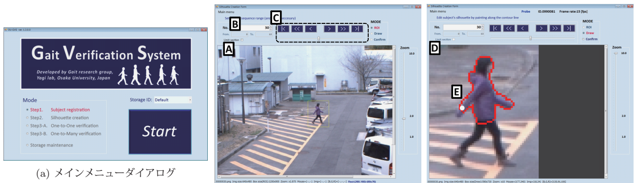
図 4 メインメニュー、登録モジュール、シルエット生成モジュールのインターフェースダイアログ。(A) 入力画像列、(B) 表示されている画像のフレーム番号、(C) 画像列閲覧制御パネル、(D) 対象の切り抜き画像、(E) 対象のシルエットの輪郭線 (赤線)。
