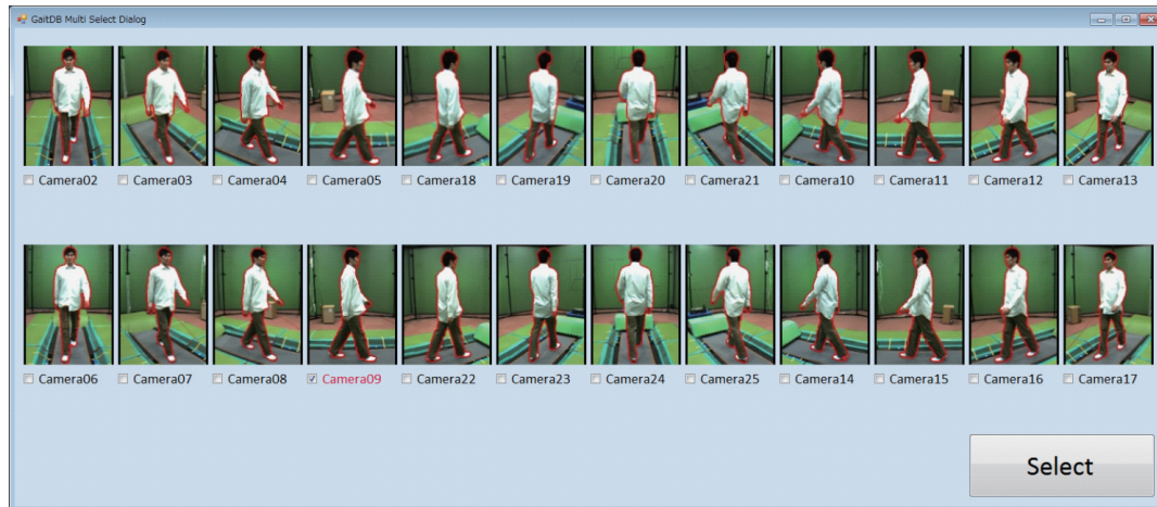
図 8 観測方向選択ダイアログ. ユーザはこのダイアログに表示されている各観測方向の画像を見て、入力した観測方向に最も近いものを選択する。
