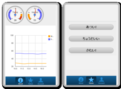
図 4：空調制御に関する体感情報入力インタフェースの例
