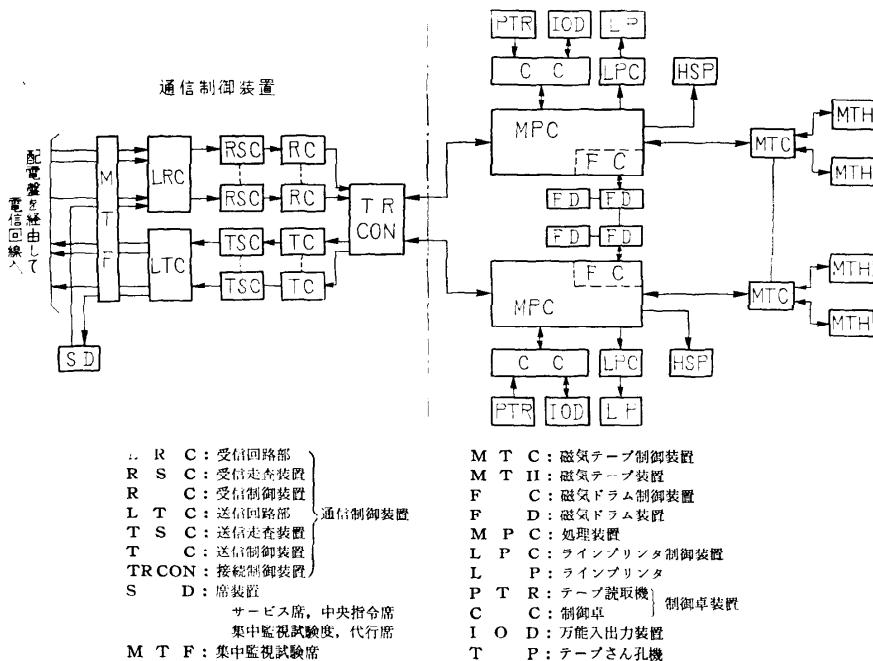
電信回線と処理装置（電子計算機）間にあって、送受情報の通過制御を行ない、次の各部に大別できる。
