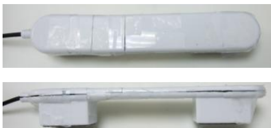
図 10 ABS 樹脂を用いた試作アンテナケース
