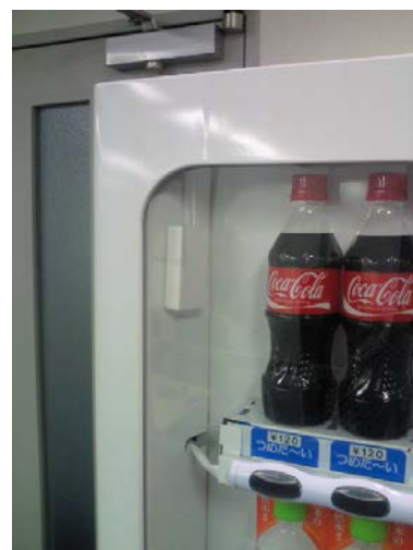
図 1 現在自販機に使用されている小型アンテナ
