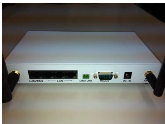
図 3 ワイヤレス M2M に使用されるルータ背面
