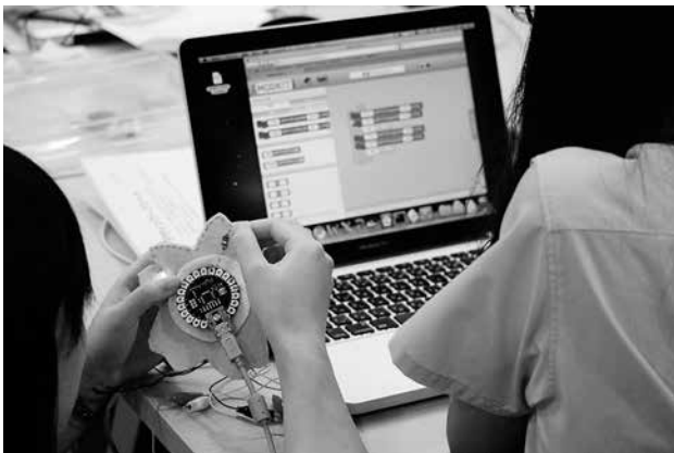
図-3 基盤とLEDの接続状態を確認しながら LilyPad Arduinoの制御プログラムを作る
