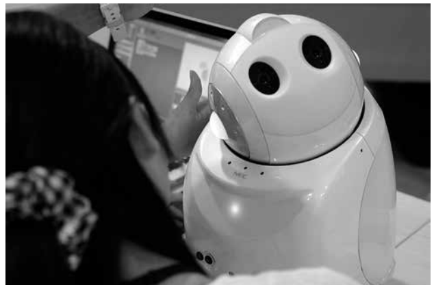
図-2 タッチセンサに反応して PaPeRo が発話するプログラミングで導入を行う
