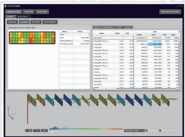
基本プロファイラを使い性能分析しているスナップショットを示す。各枠には次の情報が表示されている。 左上枠： プロセスごとのコスト情報（部分拡大図） 右上枠： プログラムループごとの性能値の一覧 下枠： プロセスごとのコスト情報（全体の3Dトポロジ表示）
