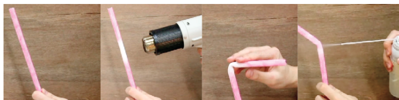
図 1 サーモクロミックインキによるチューブの剛性の可視化。 熱を与えると白くなり、冷やすとインキの色が戻る。
