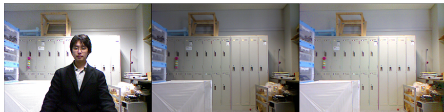
図 3 カメラからの映像 (左) と背景画像 (中) と明度を合わせた背景画像 (右)
