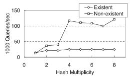
図 5 ハッシュ多重度によるブルームフィルタ付き LOUDS トライの検索性能の変化 Fig. 5 Search performance for hash multiplicity of LOUDS TRIEs with Bloom filters.
