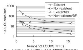
図 3 LOUDS トライの個数に対する検索速度の変化モデル Fig. 3 Search performance model for the number of LOUDS TRIEs.
