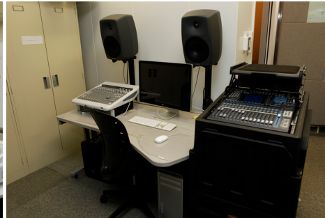
図 12 ProTools 用のコンピュータとデジタルミキサ DM1000VCM。防音室内部とマルチケーブルで接続されており柔軟な運用が可能。
