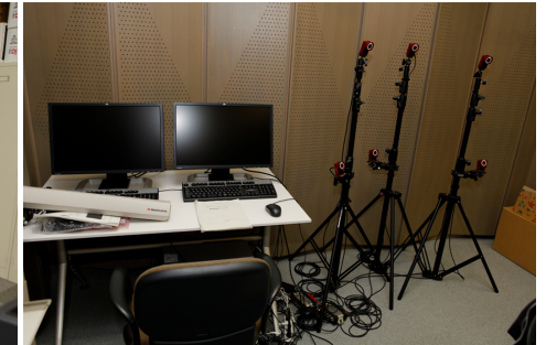
図 14 モーションキャプチャ用のコンピュータとカメラ。実際は撮影スタジオなどで収録を行う。
