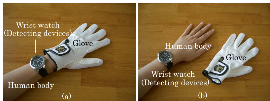
図1 着用検知機構のコンセプト
