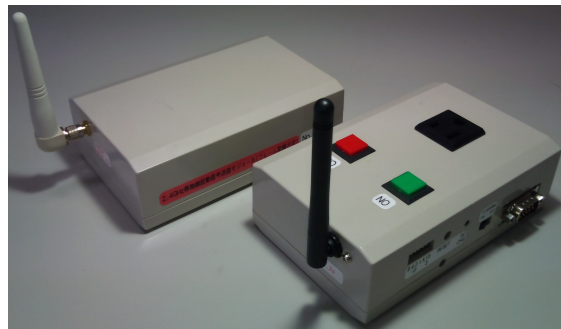
図 2 起動信号送信モジュール (左) と電源制御モジュール (右) の外観
