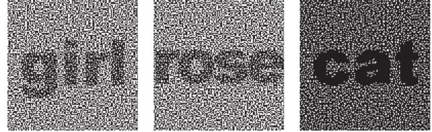
図2 拡張視覚復号型暗号の例：左と中央が透明シート上の画像、右が復元された秘密画像
