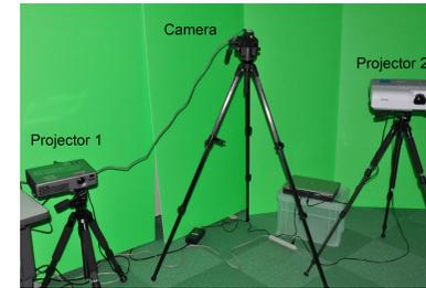
図 5 1 台のカメラと 2 台のプロジェクタで構成された実験システム
