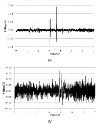
図 4 音響的ホワイトノイズ環境下でのマウスクリックにともなう観測信号: (a) 触音, (b) 音響マイク Fig. 4 Observed mouse click related signals with acoustical white noise (a) tactile sound and (b) acoustical microphone.
