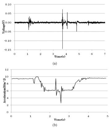
図 3 マウスクリックにともなう観測信号:(a)触音,(b)加速度
