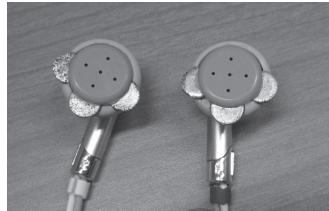
図 12 インイヤー型ヘッドホンプロトタイプ Fig. 12 In-ear headphone prototype.
