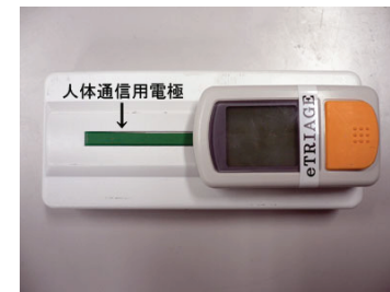
図 7 人体通信機能を搭載した負傷者タグ
