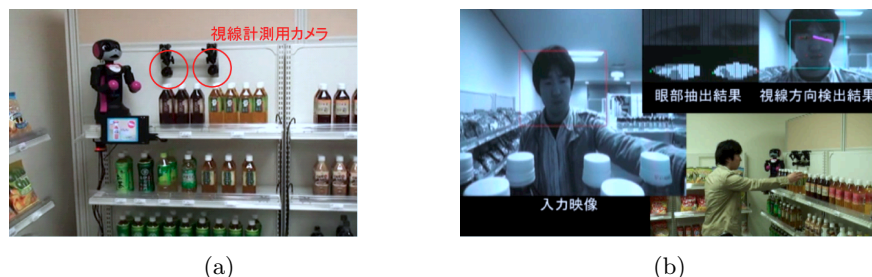
図2 視線検出のためのカメラの設置状況 (a) と検出状況の一例 (b)
