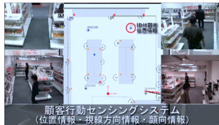
図3 位置情報と視線方向情報を統合した顧客行動センシング結果
