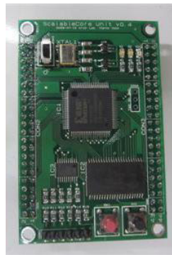
図 8 制作した ScalableCore Unit (FPGA カード)．Xilinx Spartan-3E XC3S500E と 8 bit × 512 K の容量 512 KB の SRAM を搭載する Fig.8 Our original ScalableCore Unit (FPGA Card).
