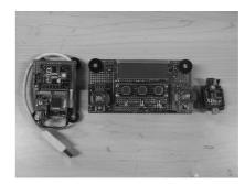
図 3 HoUZK を使ったプレゼンテーション支援装置 (左: HoUZK, 中:制御装置, 右:加速度センサ) Fig. 3 A new presentation support tool by HoUZK
