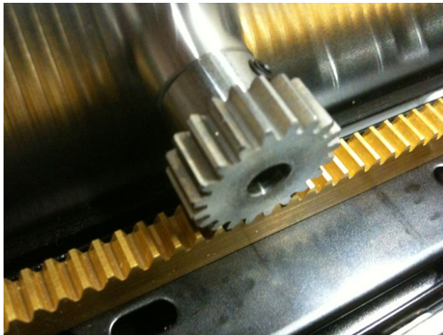
図 8 抵抗感をフィードバックする機構部分
