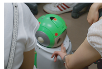
図 6 シールによるタッチセンサのマーキング
