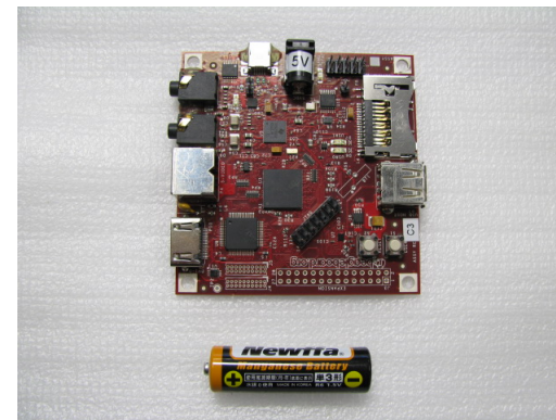
図 1 BeagleBoard(Rev.C3.0) の外観及び単三電池との大きさ比較
