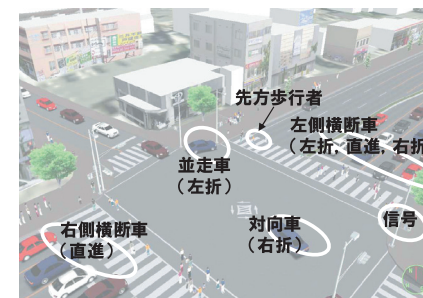
図8 図6の例における認識対象物 Fig.8 Objects for example shown in Fig.6.
