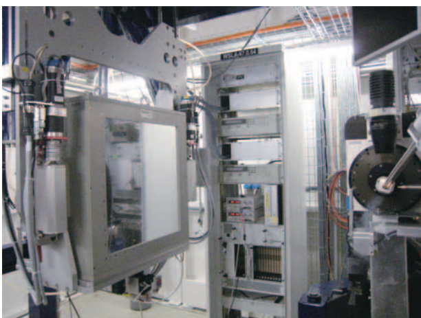
図-1 Paul Scherrer InstitutのSwiss Light Source (SLS)で開発されたPILATUS (pixel apparatus for the SLS)ディテクタ。60,000個の素子(1枚の画像あたり約6メガバイト)で構成されていて、毎秒10枚の回折像データを測定することができる。写真の左側の長方形のパネル。
