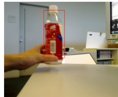
図 4 移動物体を表す矩形の抽出結果 Fig. 4 Output of moving object's rectangle
