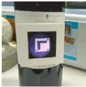
図 1 ビジュアルマーカを用いた AR 技術によるセンサ情報の可視化例
