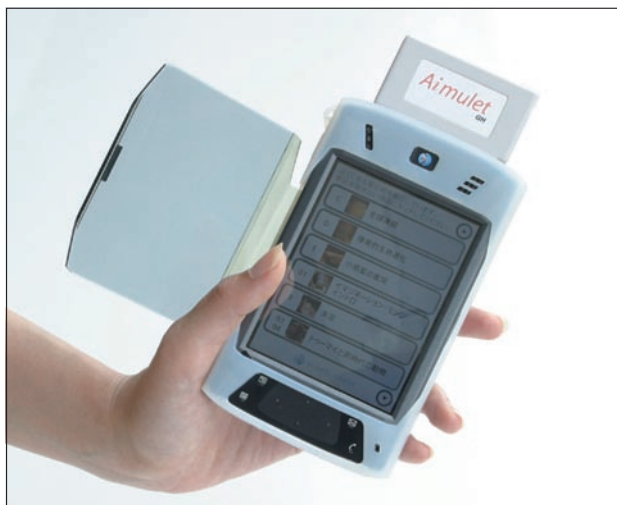
● 図-2 Aimulet GH+: アクティブ RFID を内蔵した PDA
