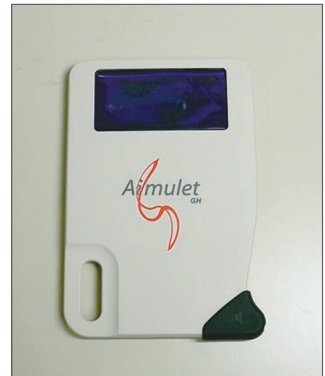
● 図-6 Aimulet GH (アクティブ RFID を内蔵した音声専用端末装置)
