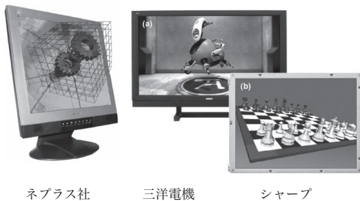
図-6 バリヤー方式の裸眼立体ディスプレイ
