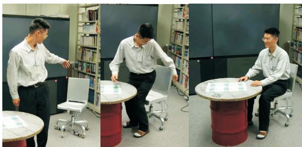
図-2 試作した自律移動椅子。ジェスチャーによって呼び寄せると、適切な位置・姿勢に寄って来て座ることができる<sup>5)</sup>。
