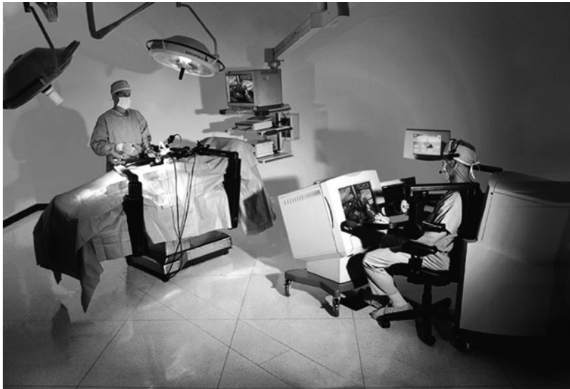
図-5 内視鏡手術操作ロボット Zeus システム (Computer Motion社, アメリカ)
