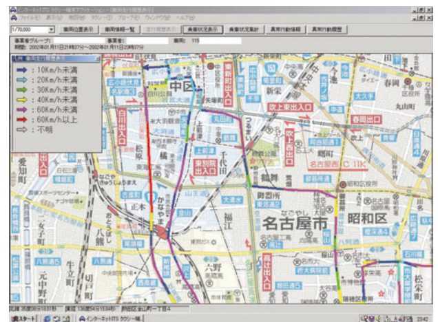
図-7 車両走行履歴表示の（速度）PC表示画面
