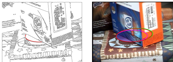
図 3 左：円形物体をわずかに含む画像から検出したエッジ画像。右：楕円弧をなす 155 点に当てはめた楕円を原画像上に重ねて表示したもの。内側から順に標準最小二乗法（ピンク）、Taubin 法（青）、提案手法（赤）、最尤推定（緑）。Taubin 法と提案手法の差は小さい。
