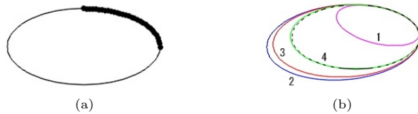
図 1 (a) 楕円上の 31 点 . (b) \sigma = 0.5 の場合の当てはめの一例 . 1. 標準最小二乗法 . 2. Taubin 法 . 3. 提案手法 . 4. 最尤推定 . 破線は真の形状 .
