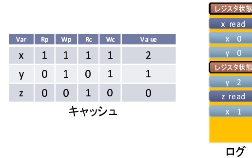
図 13 最適なロールバック・ポイントを選択するためのキャッシュとログ Fig. 13 Cache and log for the optimal rollback
