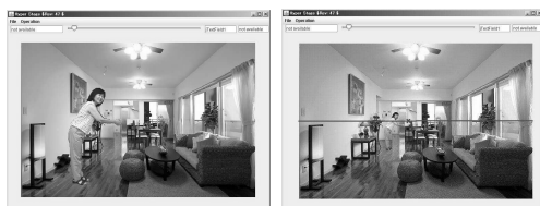
図4 部屋の写真に基本情報を書き込んでいる様子。ものさし写真(女性)を使って3次元原点の指定(左)、候補から消失点を選択(右)
